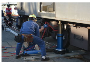
車両脱線復旧
