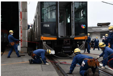
車両脱線復旧
