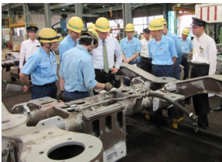
台車枠の磁粉探傷検査（社長）
