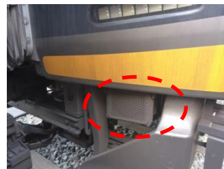
転落防止放送装置
