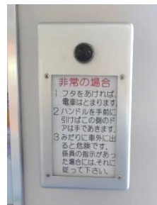
非常通報装置
