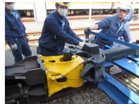
連結器アダプタを装着した連結・解放訓練
