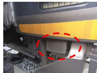
転落防止放送装置
