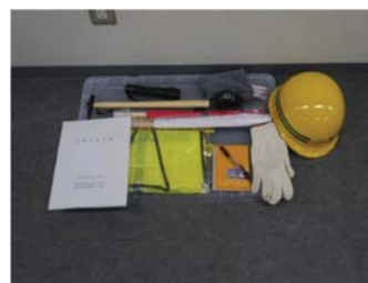
安全点検セット （電気部・工務部）
