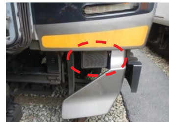
転落防止放送装置
