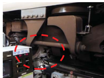
車輪を削正している箇所
