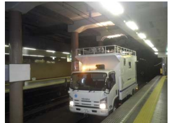
架線検測車による摩耗測定
