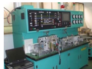
空気ブレーキ弁類自動試験装置
