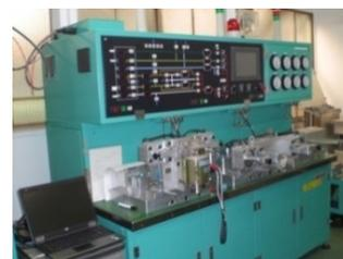
空気ブレーキ弁類自動試験装置
