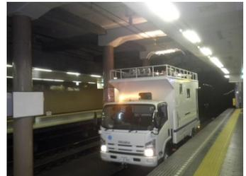
架線検測車による摩耗測定
