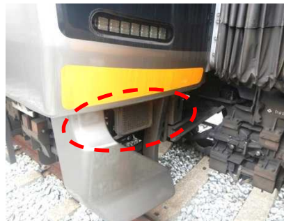
転落防止放送装置
