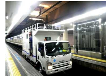
架線検測車による摩耗測定
