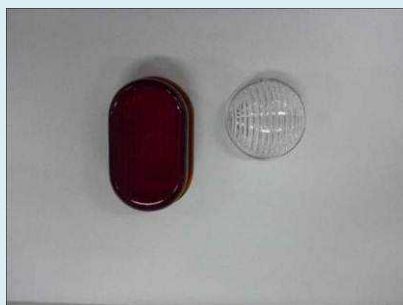
(左) 大型化した車側灯のランプカバー (右) 従来のランプカバー
