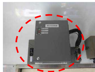
運転状況記録装置
