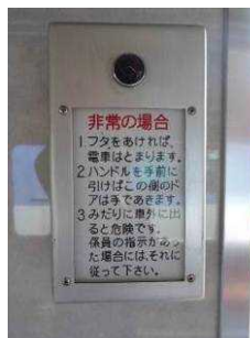
非常通報装置
