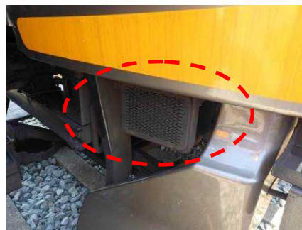
転落防止放送装置
