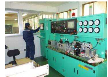
空気ブレーキ弁類自動試験装置
