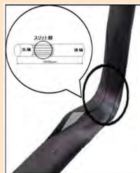
スリット形踏切遮断桿（構造）
