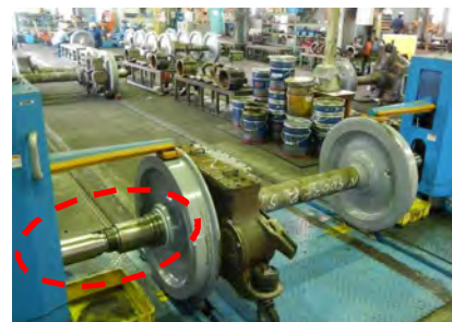
破線内から車軸に超音波を発振
