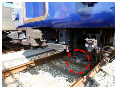
破線内が地上からのATS信号を受ける受電器
