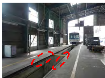
破線内がひずみゲージ設置箇所
