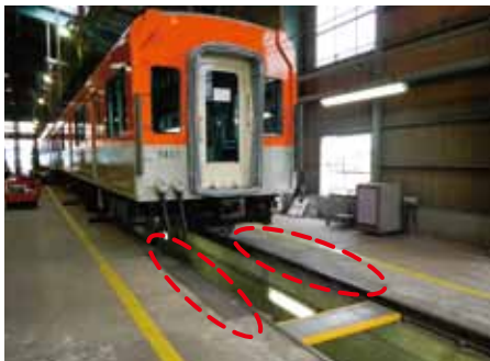
破線内がひずみゲージ設置箇所
