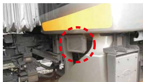
破線内が転落防止放送装置
