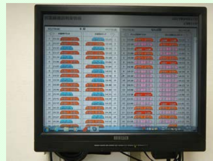
車両在線表示システムモニタ（本線）
