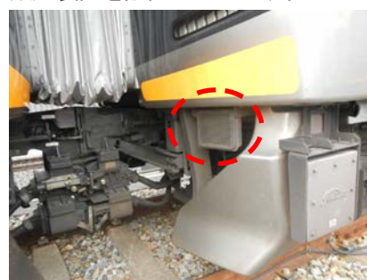
破線内が転落防止放送装置
