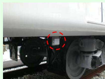
破線内がIDプレート
