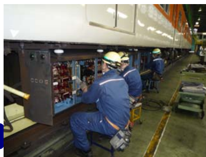
【状態・機能検査(月検査)】
