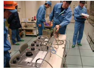
【保護継電器特性試験】
