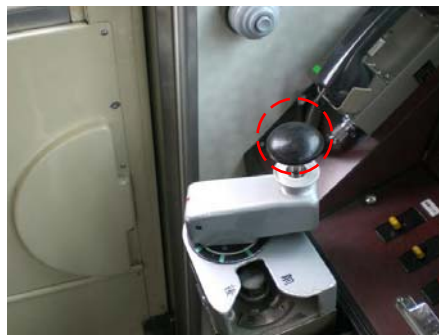
【ハンドルの破線部がデッドマンスイッチ】
