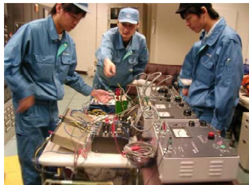
【保護継電器特性試験】
