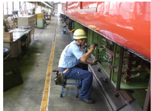
【状態・機能検査（月検査）】
