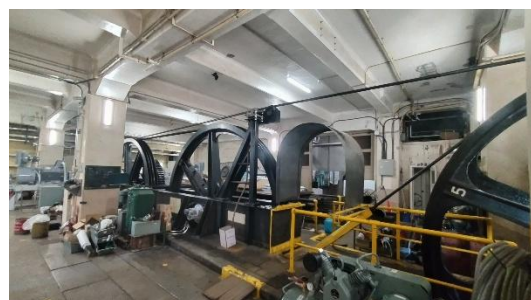
巻上場内の巻上装置（直径4mの大滑車）
