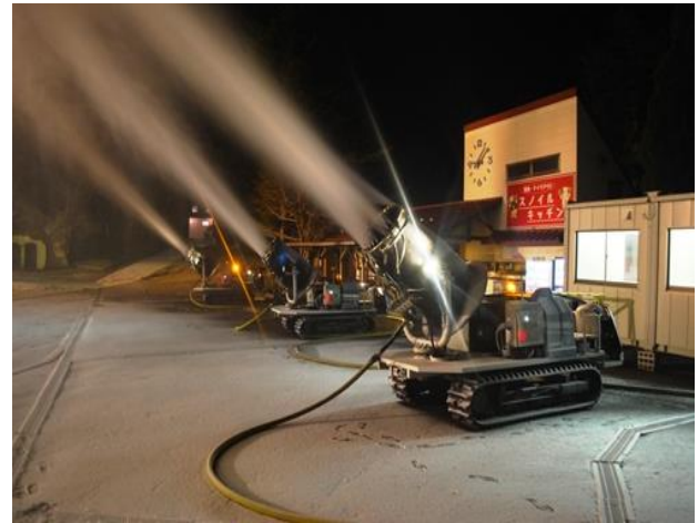
スノーファン 稼働時の様子
