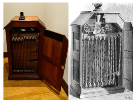
左:キネトスコープ 1891年、アメリカ(2001年復元) 右:キネトスコープ図(1894年)
