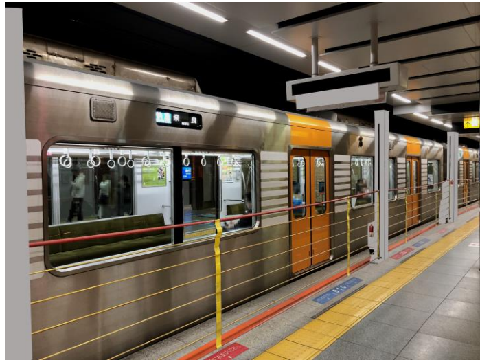
< 2番線ホーム：昇降ロープ式ホーム柵の設置イメージ（阪神車両停車時） >
