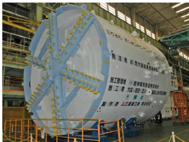
3工区のシールドマシン
